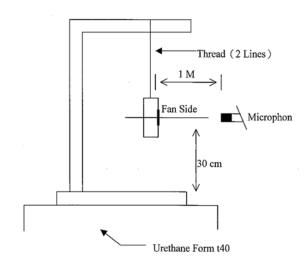
1 METER FROM MICROPHONE TO FAN INTAKE
