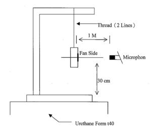
1 METER FROM MICROPHONE TO FAN INTAKE
