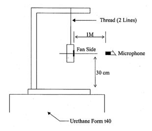
1 METER FROM MICROPHONE TO FAN INTAKE
